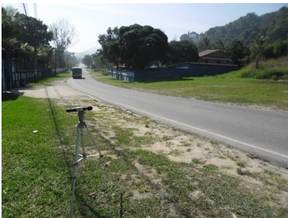
Figura 8.1.11.2-6: Medição de ruído diurno nos pontos 11 (direita) e 12 (esquerda).
