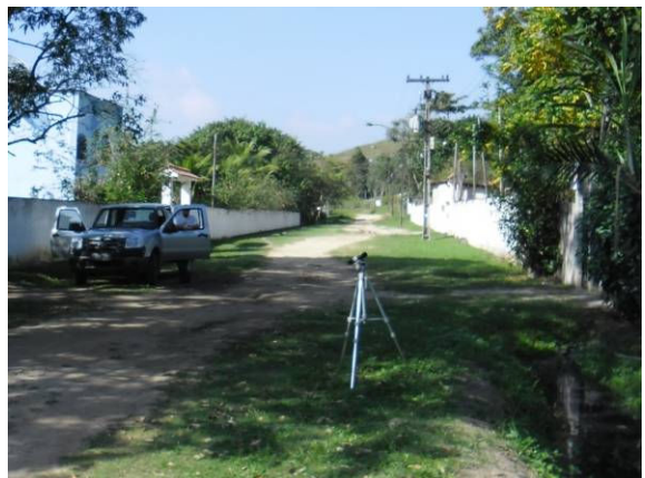
Figura 8.1.11.2-6: Medição de ruído diurno nos pontos 11 (direita) e 12 (esquerda).
