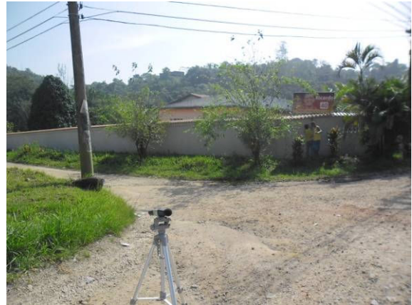
Figura 8.1.11.2-2: Medição de ruído noturno no ponto 03 (direita) e medição de ruído diurno no ponto 04 (esquerda).
