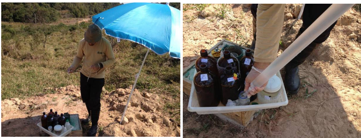
Figura 8.1.8.2.2-1. Coleta de água em um dos pontos de amostragem e enchimento dos frascos.
