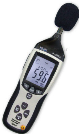
Figura 8.1.11.1-1. Decibelímetro IMPAC modelo IP-900DL utilizado nas medições de ruído.
